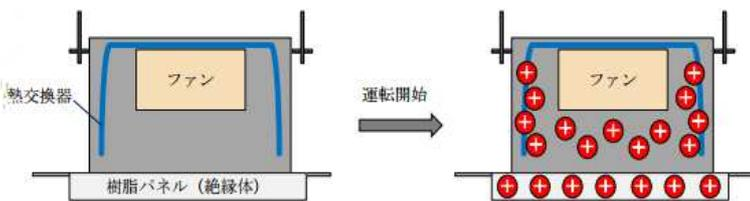
エアコン内の熱交換器(フィン)および樹脂製パネル(絶縁体)は、フィンの回転に伴う空気との摩擦により静電気が発生し、**プラス**に帯電しています。
