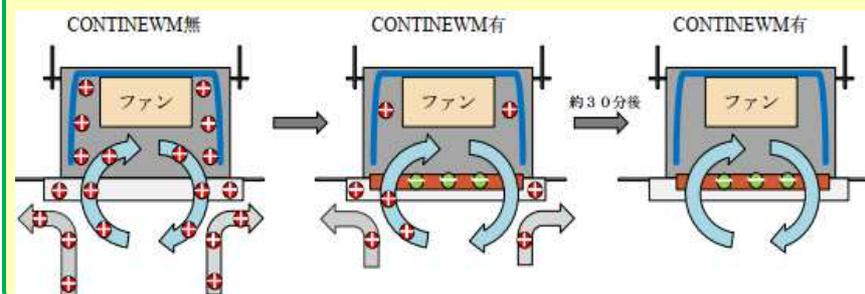
常に**マイナスに帯電している**CONTINEWMはプラスの電荷発生を抑え、無電荷状態の空気に変えます。このことで、エアコンは静電気の影響を受けず、**本来意図していた熱交換効率を発揮**することができます。
